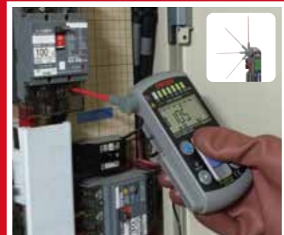
好みの角度(5段階)で固定できるブレーカーピンで、片手測定が可能。測定箇所と測定値(表示器)が近く、視線の移動を軽減できる。
